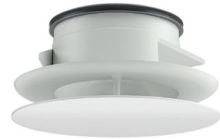
Das Lüftungsventil RLV ist für die Zu- und Abfuhr von gekühlter und erwärmter Luft und vor allem für einen optisch anspruchsvollen Wand- und Deckeneinbau geeignet. Aluminium-Frontplatte in mehreren Formen und Farben erhältlich. Schnelle und einfache Montage mit Klemmfedern oder Montagering, sowohl für Flex- als Glattrohre. Mit Doppellippendichtung ausgestattet (Luftdichtheitsklasse D nach EN 15727). Einfache Einstellung des Drosselementes. Standard RAL 9003 Strukturlack pulverbeschichtet.
