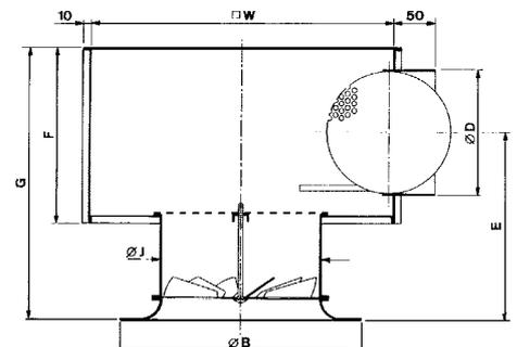
Kasten und Reduktion-Übergangsstück standard ausgestattet mit Gleichrichterperforplatte
