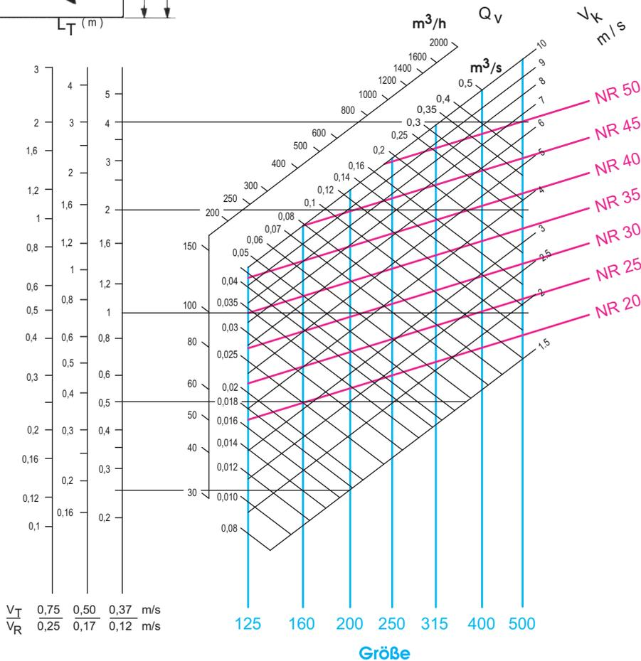
Korrektur der Wurfweite  $L_T$  bei Montage ohne Deckeneinfluss:  $L_T \times 0,8$
