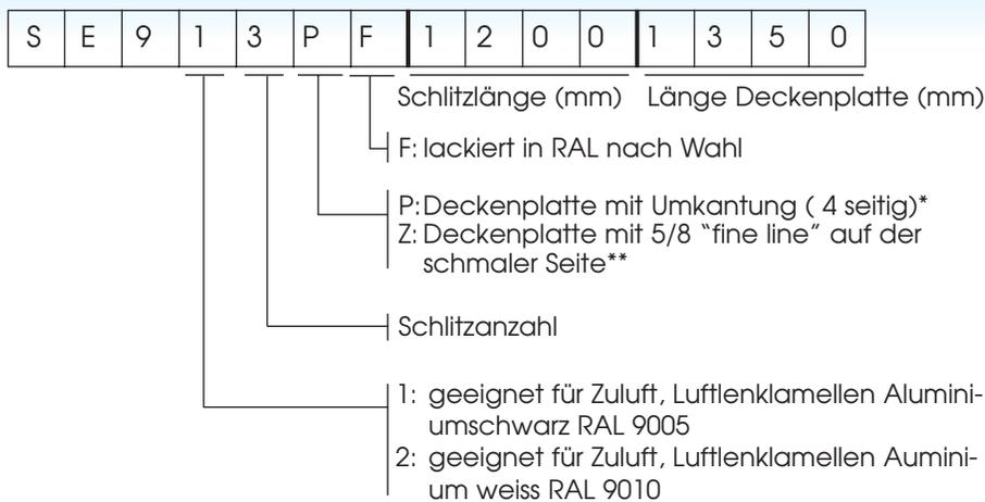
\* Standardbreite Deckenplatte 300 mm und Umkantung 10 mm (4-seitig)
