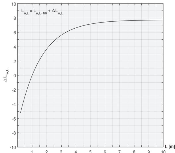
KORREKTUR DER WURFLÄNGE FÜR EINEN SCHLITZDURCHLÄSSE MIT LÄNGE L
