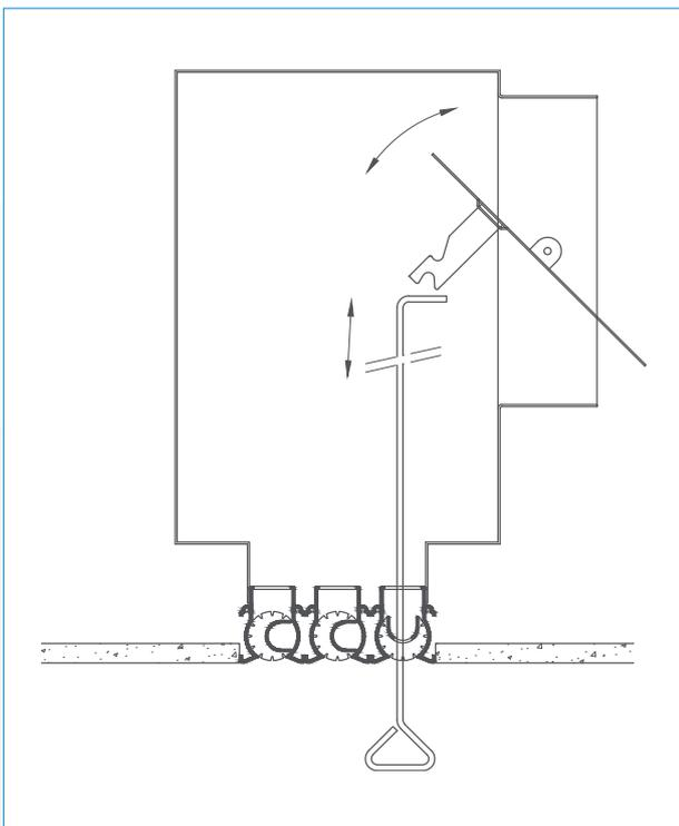
Der Walzenschlitzauslass wird (auf Anfrage bei Grada) festgenietet am Kasten. Mengenregulierung im Anschlussstutzen einstellbar durch Walzenschlitzauslass (LP310). Ausgestattet mit Aufhängeaugen, Aufhängehaschen sind auf Anfrage erhältlich.
